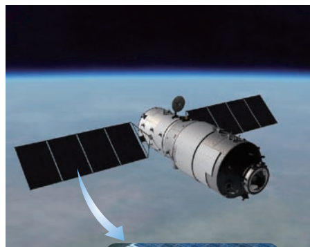
“天宫一号”上的太阳能电池板的基板是由玻璃纤维制成的。
